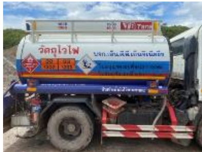
รถบรรทุกที่รอการซ่อมบำรุงได้มีการใช้เหล็กค้ำยัน กระเบื้องและหมอนรองล้อ
