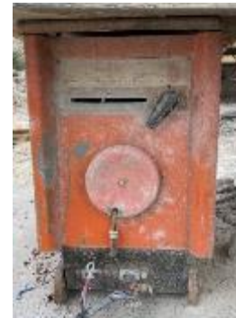
อุปกรณ์เครื่องเชื่อมใช้สายผิดปกติ และไม่มีหางปลาตามมาตรฐาน
