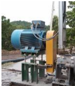
มอเตอร์ถังสุบลูเลนไม่มีการครอบ ทางผู้รับผิดชอบได้ดำเนินการติดตั้งการครอบเรียบร้อยแล้ว
