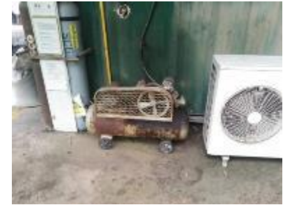
อุปกรณ์บีบลมอัดโนมิต มีการดัดครอบจุดหมุนที่ยังไม่ผ่านมาตรฐานที่กำหนด
