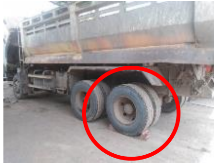
รถบรรทุกที่รอการซ่อมบำรุงได้มีการใช้เหล็กค้ำยัน กระเบื้องและหมอนรองล้อ
