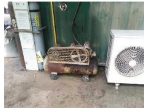
อุปกรณ์ปั๊มลมอัดโนมตี มีการครอบจุดหมุนที่ยังไม่ผ่านมาตรฐานที่กำหนด
