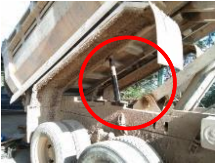
รถบรรทุกที่รอการซ่อมบำรุงได้มีการใช้เหล็กค้ำยัน กระเบื้องและหมอนรองล้อ
