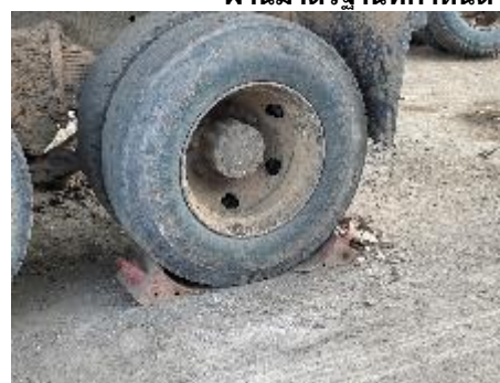
การซ่อมแซมรถบรรทุก ในทุกครั้งได้มีการรองล้อรถบรรทุกตามมาตรฐาน
